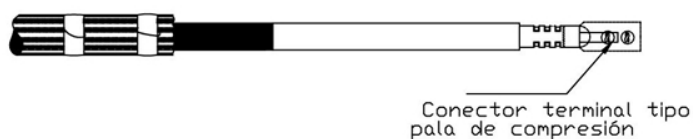
Figura 3. Instalación de la borna terminal
