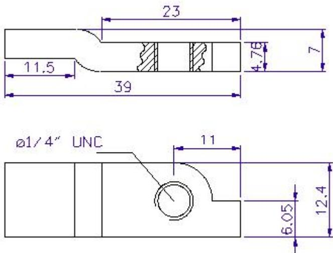
**FIGURA 9. LLAVE PARA PERNO DEL SISTEMA DE SEGURIDAD**
